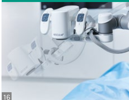
Abb. 15-17: Wegpunkte: Mit nur einem Knopfdruck zur zuvor gespeicherten Position zurückkehren inkl. Licht, Zoom und Fokuseinstellungen
