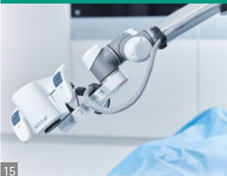
Abb. 15-17: Wegpunkte: Mit nur einem Knopfdruck zur zuvor gespeicherten Position zurückkehren inkl. Licht, Zoom und Fokuseinstellungen
