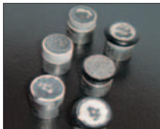
Prüfzylinder nach der Oberflächenbelastung
